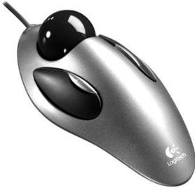
بعض مستخدمي الحاسب لا يحبون الفأرة بسبب المساحة التي تحتاجها لكي تتحرك بها بسهولة فقد تكون المساحة ضيقة فيشعر المستخدم بالضيق وعدم الارتياح ولذلك ظهرت وحدة الإدخال " كرة التتبع " التي يمكن للمستخدم التعامل معها بدوران الكرة فقط بأصابعه دون حركة الوحدة
